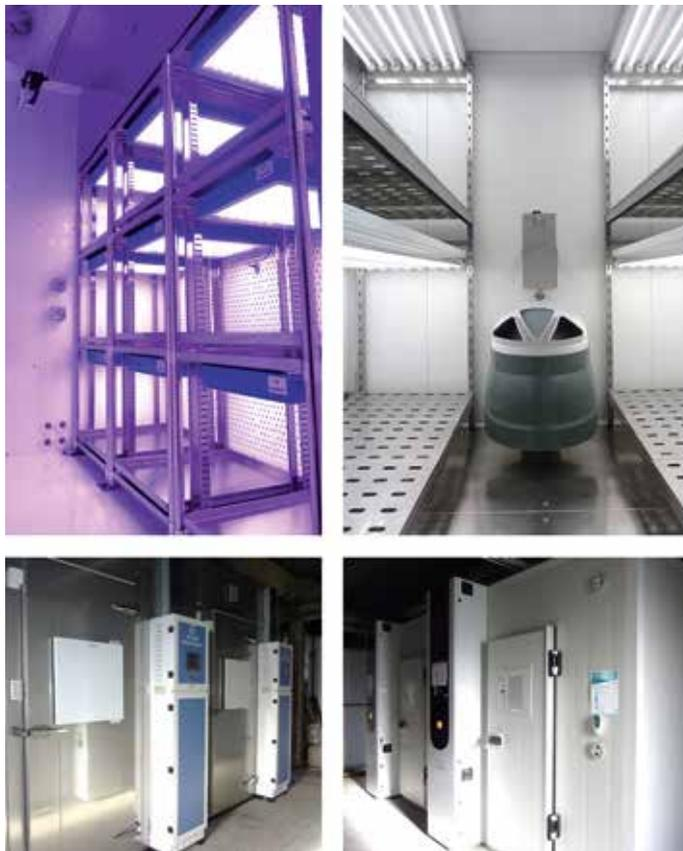
Photos des quatre nouvelles chambres climatiques à l'Inrae (33). Photos de l'intérieur des chambres en haut et de l'extérieur en bas, des chambres de la marque Bionef à gauche et de la marque Aralab à droite.
